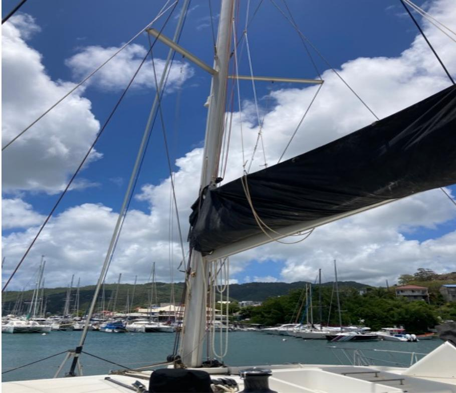
Le gréement roulant devra être remplacé ;
